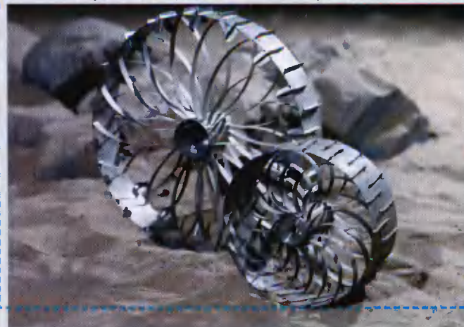
Прототип колеса с металлоупругой "шиной" (вверху), другие экспериментальные варианты колес для планетоходов (внизу)
