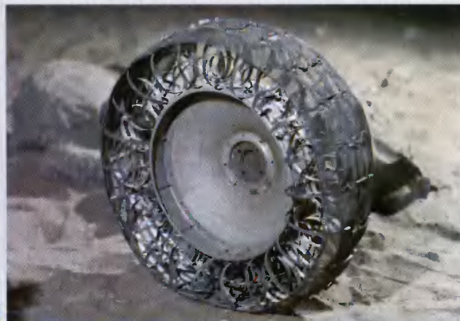
Прототип колеса с металлоупругой "шиной" (вверху), другие экспериментальные варианты колес для планетоходов (внизу)
