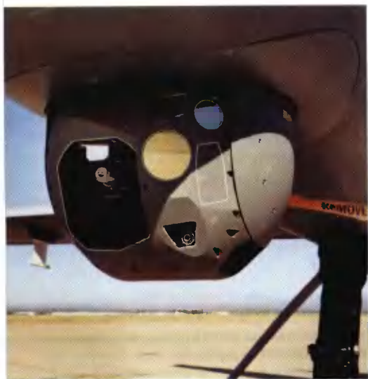
В турели под брюхом самолета в носовой части установлены камеры и другие датчики (слева). Пилот компании General Atomics управляет самолетом, сидя в будке наземной мобильной станции (справа)
